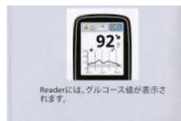
図 7 リーダーをセンサーに近づけると、グルコース値が表示される
